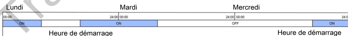
Figure 16: Si un temps ON continue après minuit un jour où l'horloge de 24 h n'est pas active, la fonction reste en marche (ON) jusqu'à ce que la durée en question se soit écoulée.
